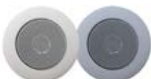
P7112 4/10 W – 8 Ohm – 84 dB (1w 1m) Respuesta en frec. 150-20000 Hz Para empotrar en falso techo. Dimensiones: Ø 80x32 mm Agujero instalación: 60 mm Fijación con muelles
