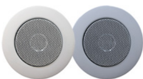
P7112 4/10 W - 8 Ohm - 84 dB (1w 1m) Respuesta en freq. 150-20000 Hz Para empotrar en falso techo. Dimensiones: Ø 80x32 mm Agujero instalación: 60 mm Fijación con muelles
