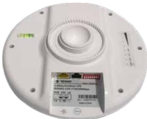
La configuración se realiza mediante switches, sin necesidad de ordenador, no obstante si la distancia entre antenas es muy próxima (<50m) es conveniente reducir la potencia de emisión accediendo al web management con un ordenador.
